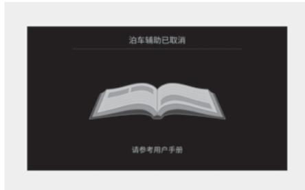
遥控泊车辅助功能工作时，可撤销此功能。无论泊车顺序如何，都会出现“**泊车辅助已取消**”警告信息。根据特定条件，可能会显示其它警告信息。使用遥控泊车辅助功能泊车期间，请遵循在信息娱乐系统上提供的操作指南。在使用遥控智能泊车辅助(RSPA)功能期间，必须始终注意观察车辆周围环境。
