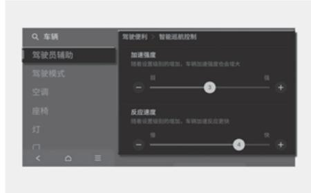
车辆电源在ON位置时，在信息娱乐系统中选择“设置 > 车辆 > 驾驶员辅助 > 驾驶便利 > 智能巡航控制(SCC)”项，可以手动设置或变更车间距离、加速强度、反应速度等设置。
