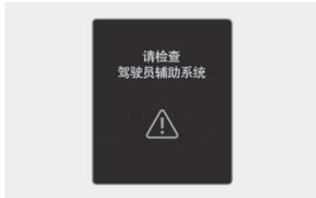
驾驶员注意力提示(DAW)系统不能正常运行时，就会在仪表盘上显示“请检查驾驶员辅助系统”的警告信息几秒钟，并且仪表盘上的主警告灯(△)和疏忽驾驶警告灯(⚠)亮。在此状态下，我们建议您将此系统有关的所有检查、维修和更换工作交由现代汽车授权经销商进行。
