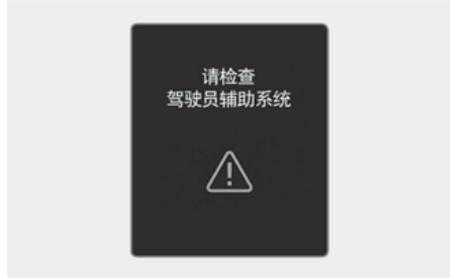
车道跟踪辅助(LFA)系统不能正常运行时，就会在仪表盘上显示“**请检查驾驶员辅助系统**”的警告信息，并且仪表盘上的主警告灯(△)亮。在此状态下，我们建议您将此系统有关的所有检查、维修和更换工作交由现代汽车授权经销商进行。
