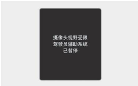
如果前挡风玻璃的前视摄像头安装部位或传感器被积雪、雨水等异物遮挡,会降低检测传感器的检测性能,这会导致车道保持辅助(LKA)功能暂停或关闭。
