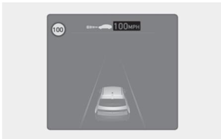
手动限速辅助(MSLA)功能或智能巡航控制(SCC)功能根据公路设置限速, 辅助车辆调整设定速度。将巡航控制速度设置为与公路设置限速匹配时, 如果公路设置限速改变, 车辆自动调整设定速度至与公路设置限速一致。此功能在设置的限速为100 km/h或以上的公路上行驶时有效。当此功能启动时, 仪表盘上的巡航速度指示灯的颜色变为绿色。
