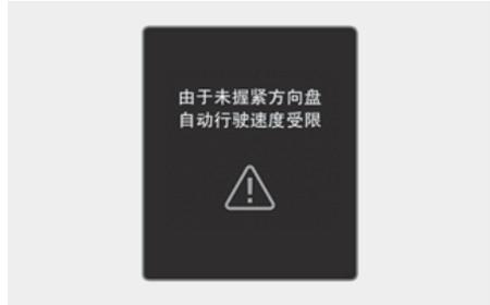
由未握方向盘警告功能控制关闭高速公路驾驶辅助(HDA)功能时，会启动车速限制功能，限制车速。
