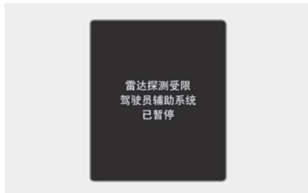
当后侧面雷达传感器或后保险杠的传感器周围被雪、雨水或安装的挂车、挂架等遮挡时,会降低雷达传感器的检测性能,这会导致安全下车辅助(SEA)功能暂停或关闭。
