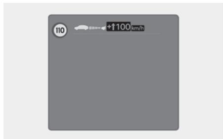
在手动限速辅助(MSLA)功能或智能巡航控制(SCC)功能控制期间，当公路设置限速发生改变时，就会以显示向上或向下箭头的方式告知驾驶员需要变更车辆设定限速。此时，驾驶员可以操作方向盘上的增速(+ )或降速(-)开关变更车辆设定限速至与公路设置限速一致。
