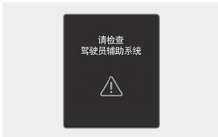
安全下车辅助(SEA)系统不能正常运行时,就会在仪表盘上显示“**请检查驾驶员辅助系统**”的警告信息几秒钟,并且仪表盘上的主警告灯(△)亮。但是,这不表示系统存在故障。在此状态下,我们建议您将此系统有关的所有检查、维修和更换工作交由现代汽车授权经销商进行。
