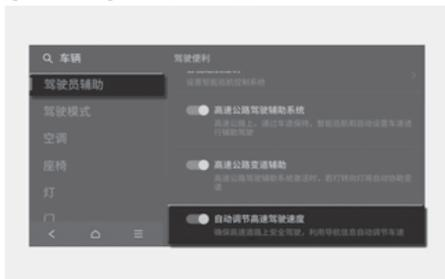
车辆电源在ON位置时，在信息娱乐系统中选择“**设置 > 车辆 > 驾驶员辅助 > 驾驶便利 > 自动调节高速驾驶速度**”项，可以设置启用或停用基于导航智能巡航控制(NSCC)功能。
