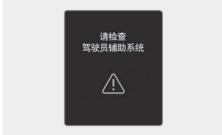
后方交叉防撞辅助(RCCA)系统不能正常运行时,就会在仪表盘上显示“请检查驾驶员辅助系统”的警告信息几秒钟,并且仪表盘上的主警告灯(△)亮。在此状态下,我们建议您将此系统有关的所有检查、维修和更换工作交由现代汽车授权经销商进行。
