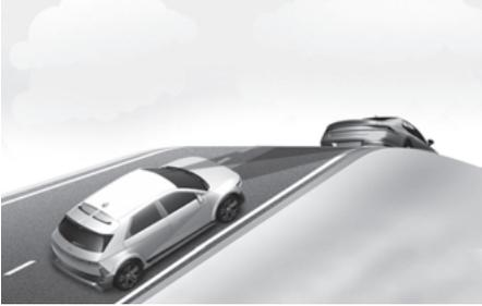
在上坡或下坡道路上行驶期间，智能巡航控制系统可能不会检测到相同车道上的车辆，车辆会加速到设定速度。此外，如果突然检测到前方车辆，车速将会迅速减慢。
