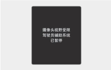
如果前挡风玻璃的前视摄像头安装部位或传感器被积雪、雨水等异物遮挡，会降低检测传感器的检测性能，这会导致智能限速辅助 (ISLA) 功能暂停或关闭。在此状态下，就会在仪表盘上显示“摄像头视野受限，驾驶员辅助系统已暂停”的警告信息，并且仪表盘上的限速警告灯(⊖)亮。
