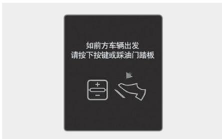
在交通拥堵道路上, 如果前方车辆停车, 本车辆也停车。同样, 如果前方车辆起步驶离, 本车辆也起步行驶。此外, 如果车辆停车的时间超过规定时间, 就会在仪表盘上显示“**如前方车辆出发, 请按下按键或踩油门踏板**”的警告信息。此时, 踩下加速踏板, 或者向上/向下拨动开关至增速(+)或降速(-)位置, 或者按下[II⊂]按钮起步行驶。
