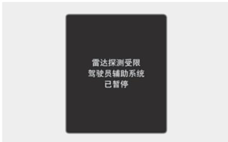
当后侧面雷达传感器或后保险杠的传感器装配部位周围被积雪、雨水等异物或安装的挂车、挂架等遮挡时，会降低雷达传感器的检测性能，这会导致安全下车预警 (SEW) 功能暂停或关闭。
