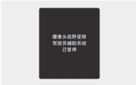
如果前挡风玻璃的前视摄像头安装部位或传感器被积雪、雨水等异物遮挡,会降低检测传感器的检测性能,这会导致驾驶员注意力警告(DAW)功能暂停或关闭。在此状态下,会在仪表盘上显示警告信息,并且仪表盘上的主(△)警告灯和驾驶员注意力(⚠)警告灯亮。当清除积雪、雨水等异物时,驾驶员注意力警告(DAW)功能将恢复至正常运行。清除积雪、雨水等异物后,如果驾驶员注意力警告(DAW)功能仍然不能正常运行,我们建议您将此系统有关的所有检查、维修和更换工作交由现代汽车授权经销商进行。
