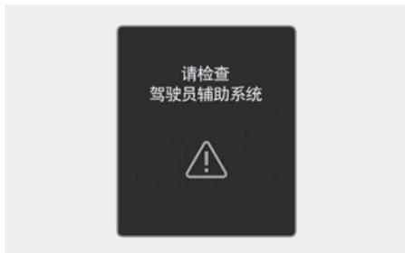
泊车防撞辅助(PCA)系统或其它有关系统不能正常运行时, 就会在仪表盘上显示“**请检查驾驶员辅助系统**”的警告信息, 并自动关闭泊车防撞辅助(PCA)功能。我们建议您将此系统有关的所有检查、维修和更换工作交由现代汽车授权经销商进行。
