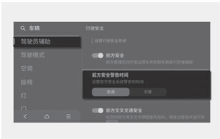
车辆电源在ON位置时，在信息娱乐系统中选择“设置 > 车辆 > 驾驶员辅助 > 行驶安全 > 前方安全警告时间”项，可以设置或变更正面防撞辅助(FCA)功能的初始警告时间。警告时间可以设置为“普通”或“较慢”模式之一。
