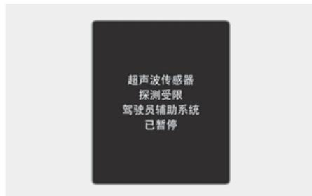
在此状态下，就会在仪表盘上显示“超声波传感器探测受限，驾驶员辅助系统已暂停”警告信息。当清除积雪、雨水等异物时，泊车距离警告(PDW)功能将恢复至正常运行。清除积雪、雨水等异物或拆除挂车、挂架等后，如果泊车距离警告(PDW)功能仍然不能正常运行，我们建议您将此系统有关的所有检查、维修和更换工作交由现代汽车授权经销商进行。
