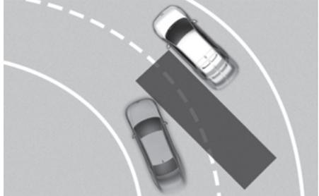
在弯道上行驶时，盲点防撞辅助(BCA)功能可能不能正常运行。在此状态下，此功能可能无法检测到相邻车道内的目标车辆。
