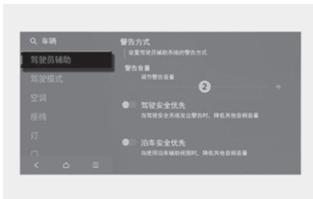
车辆电源在ON位置时，在信息娱乐系统中选择“设置>车辆>驾驶员辅助>警告方式”项，可以如下进行设置或变更：
