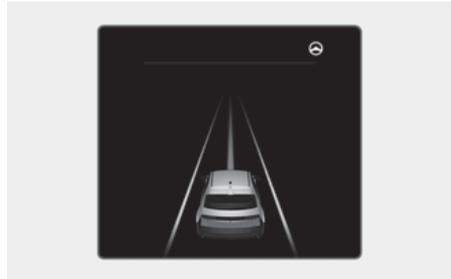
当检测到前方车辆和/或两侧车道线，并且本车车速在200km/h以下时，就会在仪表盘上绿色指示灯(Ⓛ)亮。此时，车道跟踪辅助(LFA)功能通过采取转向辅助控制，辅助驾驶员将车辆保持在车道中央行驶。
