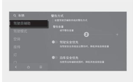
车辆电源在ON位置时,请在信息娱乐系统设置菜单中选择“设置 > 车辆 > 驾驶员辅助 > 警告方式”项。
