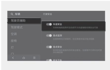
车辆电源在ON位置时，在信息娱乐系统中选择“**设置 > 车辆 > 驾驶员辅助 > 行驶安全 > 车道安全**”项，可以设置启用或停用此功能。
