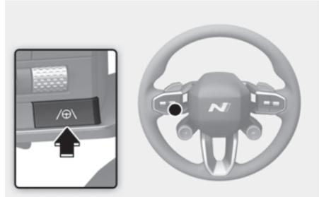
车辆电源在ON位置时，短暂按下方向盘上的车道驾驶辅助按钮，车道跟踪辅助(LFA)功能就会启动。仪表盘上的灰色或绿色指示灯(Ⓛ)亮。
