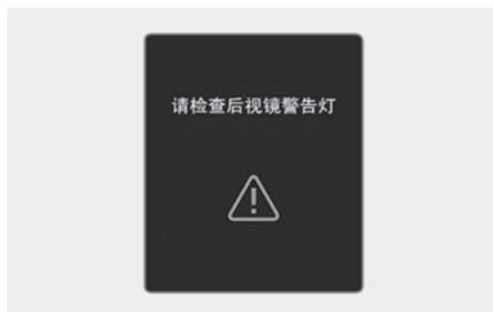
侧后视镜上的警告灯不能正常操作时,就会在仪表盘上显示“请检查侧后视镜警告灯”的警告信息几秒钟,并且仪表盘上的主警告灯(△)亮。在此状态下,我们建议您将此系统有关的所有检查、维修和更换工作交由现代汽车授权经销商进行。
