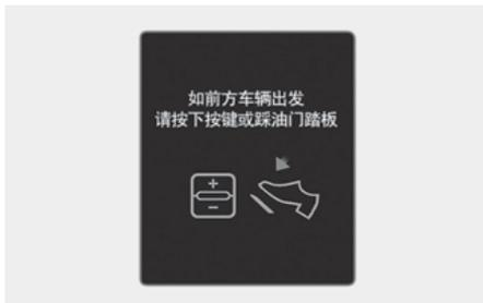
在高速公路驾驶辅助(HDA)功能启动状态，如果前方车辆停车，本车辆也会停车。同样，如果在停车后30秒钟内前方车辆起步驶离，本车辆也起步行驶。此外，如果车辆停车的时间超过30秒钟，就会在仪表盘上显示“如前方车辆出发，请按下按键或踩油门踏板”的警告信息。此时，踩下加速踏板，或者向上/向下拨动开关至增速(+)或降速(-)位置，或者按下HIC按钮起步行驶。
