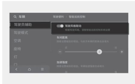
车辆电源在ON位置时，在信息娱乐系统中选择“设置 > 车辆 > 驾驶员辅助 > 驾驶便利 > 智能巡航控制 > 驾驶风格联动”项，可以设置启用驾驶风格联动智能巡航控制(SCC)功能，如“车间距离”、“加速强度”和“反应速度”。
