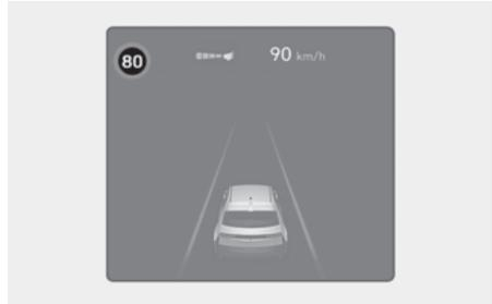
当车速超过显示的限速时，设定限速指示灯的颜色将变为红色。
