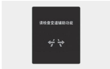
高速公路驾驶辅助(HDA)系统不能正常运行时，就会在仪表盘上显示“**请检查驾驶员辅助系统**”和“**请检查变道辅助功能**”的警告信息，并且仪表盘上的主警告灯(△)亮。在此状态下，我们建议您将此系统有关的所有检查、维修和更换工作交由现代汽车授权经销商进行。
