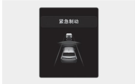
在仪表盘显示器上会显示“紧急制动”的警告信息,并发出警报声,向驾驶员发出警报,并采取紧急制动辅助措施。
