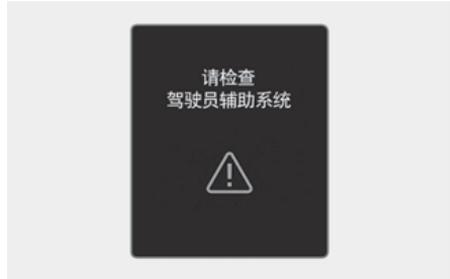
盲区防撞辅助(BCA)系统不能正常运行时，就会在仪表盘上显示“**请检查驾驶员辅助系统**”的警告信息，并且仪表盘上的主警告灯(△)亮。在此状态下，我们建议您将此系统有关的所有检查、维修和更换工作交由现代汽车授权经销商进行。
