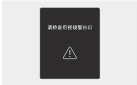
外后视镜上的警告灯不能正常操作时，就会在仪表盘上显示“**请检查侧后视镜警告灯**” (或“**请检查后视镜警告灯**”) 的警告信息几秒钟，并且仪表盘上的主警告灯 (△) 亮。在此状态下，我们建议您将此系统有关的所有检查、维修和更换工作交由现代汽车授权经销商进行。
