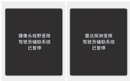
如果前挡风玻璃的前视摄像头安装部位、前雷达传感器盖、保险杠(如有配备)或传感器被积雪、雨水等异物遮挡,会降低检测传感器的检测性能,这会导致正面防撞辅助(FCA)功能暂停或关闭。
