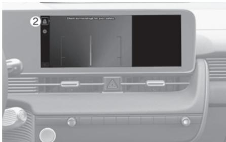
驻车操作期间，触摸显示器屏幕上的图标(2)时，在显示器屏幕上会显示顶视图像，并显示与后方车辆之间的车距。
