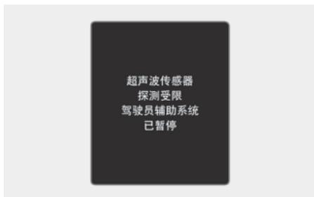
在下列条件下, 就会在仪表盘上显示“**摄像头视野受限, 驾驶员辅助系统已暂停**”或“**超声波传感器探测受限, 驾驶员辅助系统已暂停**”的警告信息:
