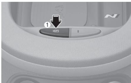
档位在“P(驻车)”档、“D(前进)”档和“N(空档)”档状态，按下驻车/影像模式按钮(1)时，后视监视器(RVM)功能启动。
