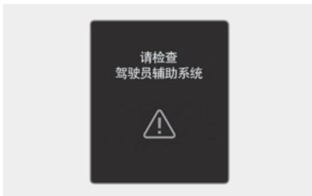
智能限速辅助 (ISLA) 系统不能正常运行时, 就会在仪表盘上显示 “请检查驾驶员辅助系统” 的警告信息, 并且仪表盘上的主警告灯 (△) 和限速警告灯 (⊖) 亮。在此状态下, 我们建议您将此系统有关的所有检查、维修和更换工作交由现代汽车授权经销商进行。
