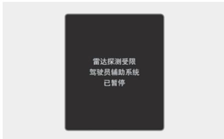
当后侧面雷达传感器或后保险杠的传感器装配部位周围被积雪、雨水等异物或安装的挂车、挂架等遮挡时，会降低雷达传感器的检测性能，这会导致盲点防撞辅助 (BCA) 功能暂停或关闭。
