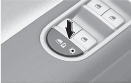
此外，当电动儿童安全锁在闭锁位置，而且检测到驶近盲点的目标车辆时，如果驾驶员按下电动儿童安全锁(🔒)按钮试图开锁儿童安全锁，电动儿童安全锁也不会开锁，以阻止打开后车门。
