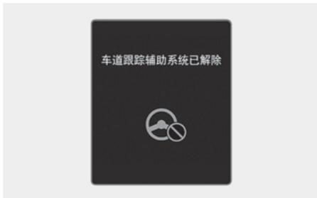
在未握方向盘警告功能发出警报后，如果驾驶员仍然没有握住方向盘，将会显示“车道跟踪辅助系统已解除”的警告信息，并且自动关闭车道跟踪辅助(LFA)功能。
