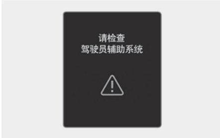
车道保持辅助(LKA)系统不能正常运行时,就会在仪表盘上显示“**请检查驾驶员辅助系统**”的警告信息,并且仪表盘上的主警告灯(△)和黄色车道安全警告灯(↔)亮。在此状态下,我们建议您将此系统有关的所有检查、维修和更换工作交由现代汽车授权经销商进行。
