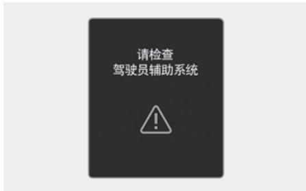
正面防撞辅助(FCA)系统不能正常运行时,就会在仪表盘上显示“**请检查驾驶员辅助系统**”的警告信息,并且仪表盘上的警告灯 $\triangle$ 亮。我们建议您将此系统有关的所有检查、维修和更换工作交由现代汽车授权经销商进行。
