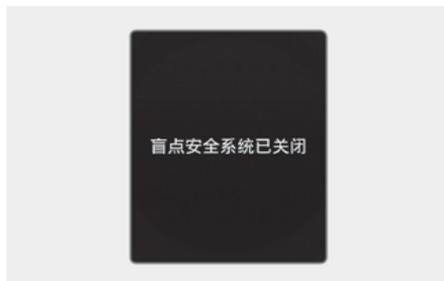
起动车辆时，如果盲点防撞辅助 (BCA) 功能在“关闭”状态，就会在仪表盘上显示“盲点安全系统已关闭”的警告信息。
