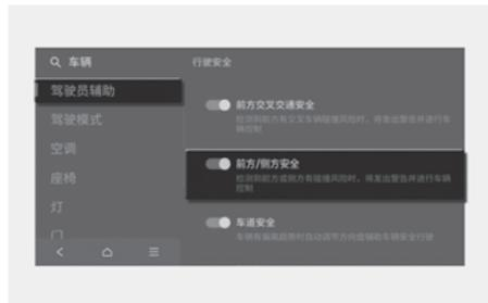
车辆电源在ON位置时，在信息娱乐系统中选择或取消选择“设置 > 车辆 > 驾驶员辅助 > 行驶安全 > 前方/侧方安全”项，可以设置启用或停用此功能。
