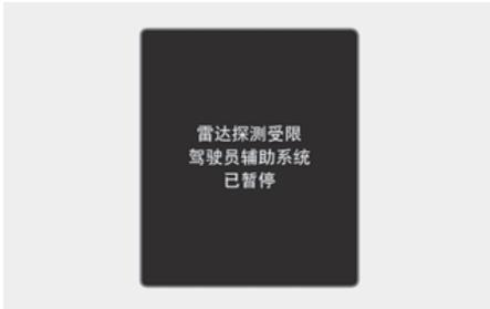
当前雷达传感器盖或传感器被积雪、雨水等异物遮挡时，会降低检测传感器的检测性能，这会导致智能巡航控制(SCC)功能暂停或关闭。
