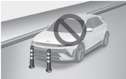
当停车位附近有狭窄的物体、圆形立柱、方形立柱或被灭火器等物体包围的立柱时，遥控智能泊车辅助(RSPA)功能的性能可能会降低，或者与障碍物发生碰撞。此时，驾驶员必须手动操作泊车。
