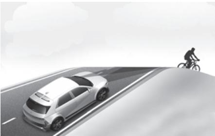
在上坡或下坡道路上行驶时，会严重影响正面防撞辅助 (FCA) 传感器的检测性能，正面防撞辅助 (FCA) 功能可能检测不到前方的车辆、动力两轮车、行人或骑行者。
