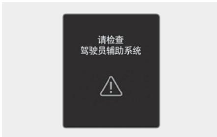
智能巡航控制(SCC)系统不能正常运行时，就会在仪表盘上显示“**请检查驾驶员辅助系统**”的警告信息，并且仪表盘上的主警告灯(△)亮。我们建议您将此系统有关的所有检查、维修和更换工作交由现代汽车授权经销商进行。
