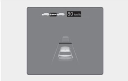
在智能巡航控制(SCC)功能控制期间,如要临时加速而不改变设定速度,可以踩下加速踏板加速。当踩下加速踏板时,仪表盘上的巡航控制设定速度、设定车距等级和目标车距将会闪烁。
