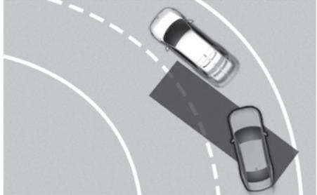
在弯道上行驶时，盲点防撞辅助(BCA)功能可能不能正常运行。在此状态下，此功能可能会检测到相同车道内的后方车辆。
