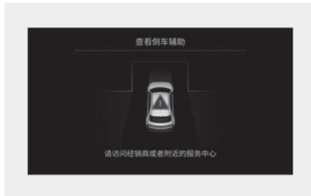
遥控智能泊车辅助(RSPA)系统不能正常运行时，就会在信息娱乐系统显示屏上显示“**查看倒车辅助**”的警告信息。如果显示此警告信息，停止使用遥控智能泊车辅助(RSPA)功能。我们建议您将此系统有关的所有检查、维修和更换工作交由现代汽车授权经销商进行。
