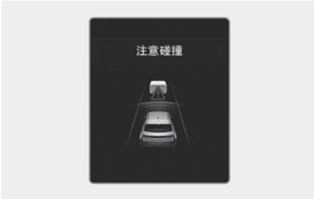
在智能巡航控制(SCC)功能控制状态下,如果检测到存在与前方车辆发生碰撞的高危险性,就会在仪表盘上显示“注意碰撞”的警告信息,同时发出警报声,向驾驶员发出碰撞危险预警。驾驶车辆时,始终要注意观察前方路况,必要时踩下制动踏板减速,以保持安全车距。
