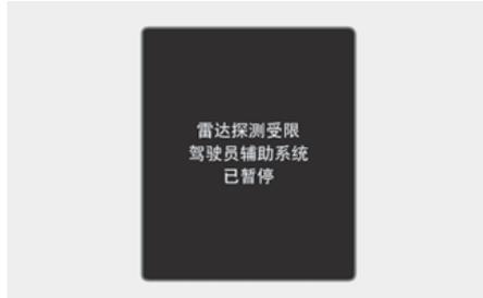
当后侧面雷达传感器或后保险杠的传感器装配部位周围被积雪、雨水等异物或安装的挂车、挂架等遮挡时,会降低雷达传感器的检测性能,这会导致后方交叉防撞辅助(RCCA)功能暂停或关闭。
