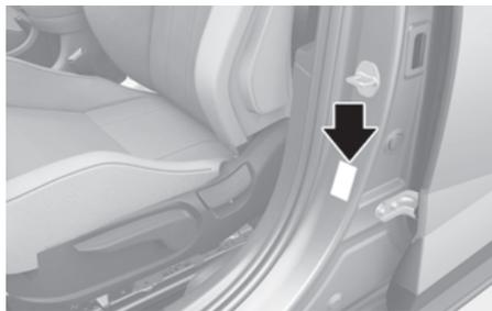
在驾驶员侧中央立柱上的轮胎标签上可以查到轮胎所有规格(轮胎尺寸、气压等)。
