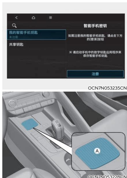
A: 车载认证板(无线充电板)
