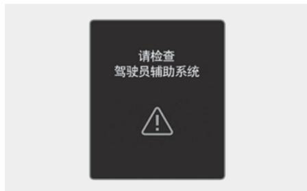
远光灯辅助(HBA)系统不能正常运行时, 就会在仪表盘上显示“**请检查驾驶员辅助系统**”的警告信息, 并且仪表盘上的主警告灯(
