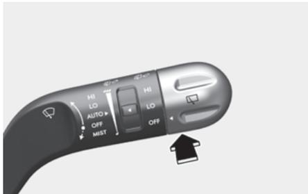
向前推动雨刮器&喷水器控制杆，后喷水器启动向后窗玻璃喷射清洗液，同时后雨刮器运转1-3周。当雨刮器&喷水器控制杆保持在此位置时，喷水器和雨刮器持续工作，直至释放雨刮器&喷水器控制杆。
