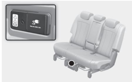
输电(V2L)安装在后排中央座位底部。V2L是便利功能，可提供足够的电力，以便在车内使用各种家用电器。
