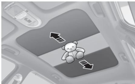
如果在电动遮光板自动关闭期间检测到障碍物的阻力，电动遮光板或天窗玻璃会停止移动，并自动反向操作，然后停在某个位置，以便清除障碍物。
