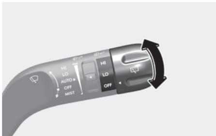
后雨刮器开关位于雨刮器控制杆的末端。将后雨刮器开关转至理想位置操作后雨刮器和喷水器。
