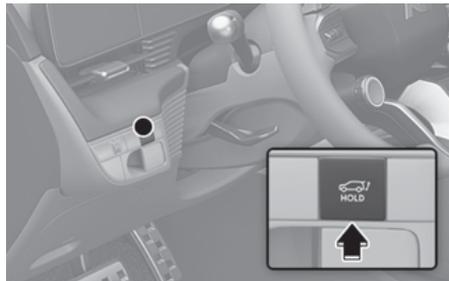
在后备箱门关闭状态下，按住电动后备箱门打开/关闭按钮约1秒钟。伴随着警报声，后备箱门自动打开。
