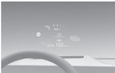
平视显示器(HUD)是选配项目,在车辆行驶过程中,允许驾驶员将视线安全的保持在前方路面上的同时,通过透明显示屏查看到投射在其上的各种信息。
