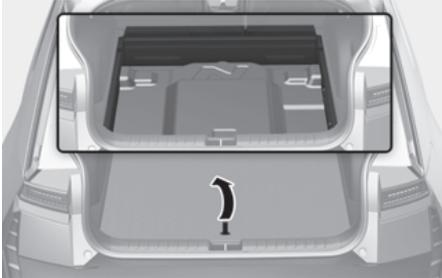
行李箱托盘用于存放工具等小件物品。要使用行李箱托盘，请握住手柄抬起顶部的板。
