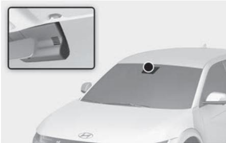
位于挡风玻璃上端的雨量传感器检测降雨量，并以适当的间隔时间控制雨刮器运转周期。
