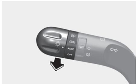
要远光灯闪烁，向后拉动灯光控制杆并释放。如果将灯光控制杆保持在向后拉动位置，远光灯会保持亮，直至释放灯光控制杆。
