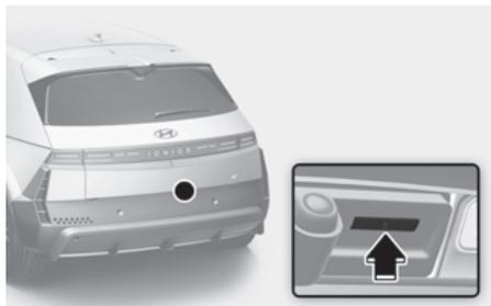
在后备箱门关闭状态，按下电动后备箱门打开/关闭按钮时，电动后备箱门打开。
