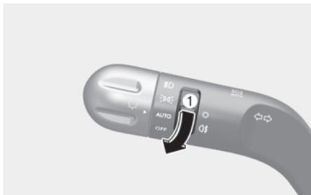
要打开后雾灯，按照下述操作将灯光开关置于“大灯”位置，然后将雾灯开关(1)拨动至后雾灯位置。
