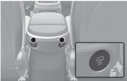
USB 充电接口通过 USB 数据线进行连接，为小型电子设备的电池充电。
