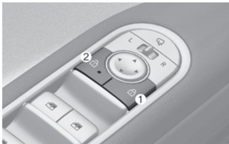
按下中央控制门锁操纵开关的Ⓐ部分(1)时，所有门锁闭锁。
