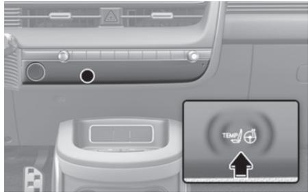
按下前加热/通风控制面板内的TEMP/HEAT按钮。
