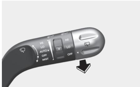
雨刮器&喷水器控制杆在**关闭(OFF)**位置时，向后拉动雨刮器&喷水器控制杆，喷水器启动向挡风玻璃喷射清洗液，同时雨刮器运转1-3周。当雨刮器&喷水器控制杆保持在此位置时，喷水器和雨刮器持续工作，直至释放雨刮器&喷水器控制杆。如果喷水器不工作，可能是挡风玻璃清洗液箱空所致，需要加注挡风玻璃清洗液。
