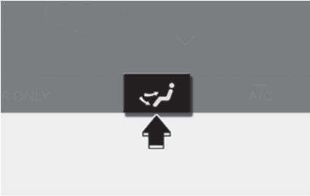
通风模式选择按钮控制从通风系统流出的气流方向。
