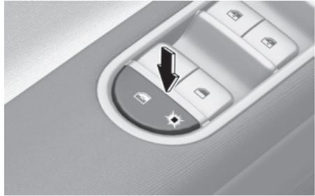
驾驶员通过按下电动门窗锁止按钮可以停用后车门上的电动门窗开关。
