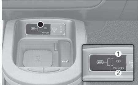
车辆运行时，按下USB接口选择按钮。按下按钮的上部(1)时，可以给电子设备充电。按下按钮的下部(2)时，可以播放多媒体存储设备内的音乐，同时给设备充电。当任何指示灯亮时，可以使用USB接口。
