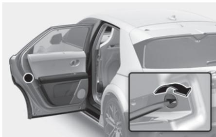
在蓄电池亏电等紧急情况下，唯一的解决方法是利用车门外侧锁筒使用机械钥匙闭锁车门。
