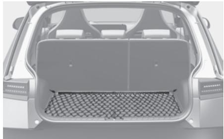
为了防止行李箱内物品移动，您可以使用行李箱侧装饰板内的4个固定钩固定行李网，罩住物品。
