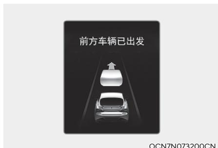
当前方停止的车辆驶离时，前方车辆出发提示功能就会在仪表盘上显示“前方车辆已出发”的提示信息，同时发出警报声，以提醒驾驶员。
