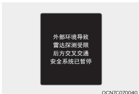
当后侧面雷达传感器或后保险杠的传感器装配部位周围被积雪、雨水等异物或安装的挂车、挂架等遮挡时，会降低雷达传感器的检测性能，这会导致后方交叉防撞辅助(RCCA)功能暂停或关闭。
