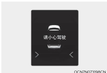
车辆通过此功能采取紧急制动辅助控制措施而停车时，就会在仪表盘上显示“请小心驾驶”的警告信息。
