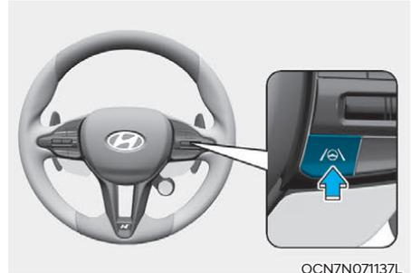
发动机运转时，按住方向盘上的车道驾驶辅助按钮(🚗)，启动或关闭车道保持辅助(LKA)功能。当车道保持辅助(LKA)功能启动时，仪表盘上的灰色或绿色车道安全指示灯(🚗)亮。
