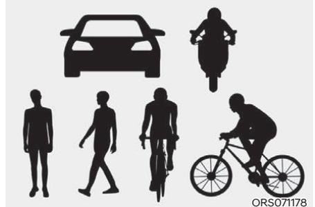
上图显示了前视摄像头检测到的车辆、动力两轮车、行人或骑行者的图像。
