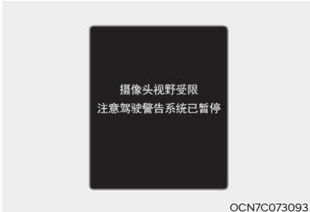
如果前挡风玻璃的前视摄像头安装部位或传感器被积雪、雨水等异物遮挡，会降低检测传感器的检测性能，这会导致驾驶员注意力提示(DAW)功能暂停或关闭。如果发生此类情况，就会在仪表盘上显示“摄像头视野受限，注意驾驶警告系统已暂停”的警告信息，并且仪表盘上的主警告灯(⚠️)和注意驾驶警告灯(🚗)亮。当清除积雪、雨水等异物时，驾驶员注意力提示(DAW)功能将恢复至正常运行。
