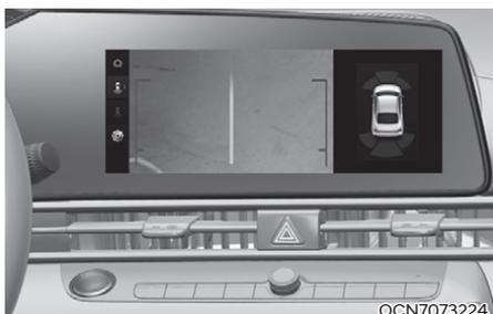
泊车操作期间，触摸显示屏上的
