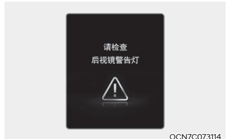
外后视镜上的警告灯不能正常操作时，就会在仪表盘上显示警告信息几秒钟，并且仪表盘上的主警告灯(△)亮。在此状态下，我们建议您将此系统有关的所有检查、维修和更换工作交由现代汽车授权经销商进行。
