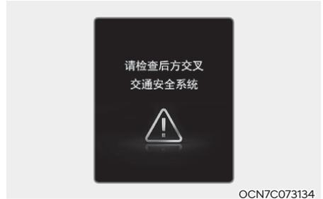
后方交叉防撞辅助(RCCA)系统不能正常运行时，就会在仪表盘上显示警告信息几秒钟，并且仪表盘上的主警告灯(△)亮。在此状态下，我们建议您将此系统有关的所有检查、维修和更换工作交由现代汽车授权经销商进行。
