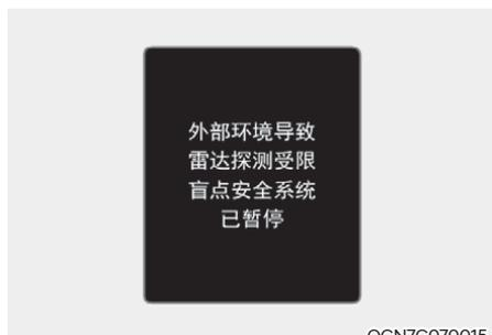
当后面雷达传感器或后保险杠的传感器装配部位周围被积雪、雨水等异物或安装的挂车、挂架等遮挡时，会降低雷达传感器的检测性能，这会导致盲点防撞辅助(BCA)功能暂停或关闭。
