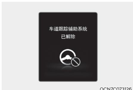
在发出未握方向盘警告后，如果驾驶员仍然没有握住方向盘，将会显示“车道跟踪辅助系统已解除”的警告信息，并自动关闭车道跟踪辅助(LFA)功能。
